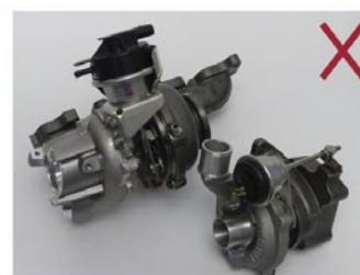
Εικόνα 1: Μη ρυθμιζόμενοι (αριστερά) και ρυθμιζόμενοι στροβιλοσυμπιεστές (δεξιά). Προσαρμογές επιτρέπονται μόνο σε μη ρυθμιζόμενα μοντέλα
