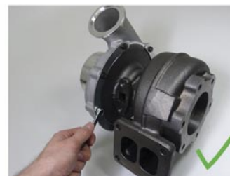
Εικόνα 2: Οι σφιγκτήρες και οι βίδες πρέπει να λασκάρουν για τη ρύθμιση
