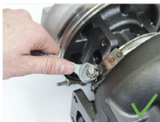
Εικόνα 2: Οι σφιγκτήρες και οι βίδες πρέπει να λασκάρουν για τη ρύθμιση
