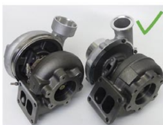
Εικόνα 1: Μη ρυθμιζόμενοι (αριστερά) και ρυθμιζόμενοι στροβιλοσυμπιεστές (δεξιά). Προσαρμογές επιτρέπονται μόνο σε μη ρυθμιζόμενα μοντέλα
